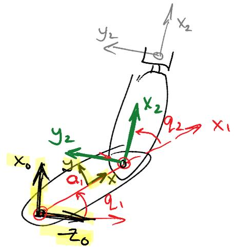
$$R_y(q_1) T_z(a_1/2) R_y(-\pi/2) R_x(-\pi/2) T_x(a_1/2) R_z(q_2) \dots$$
